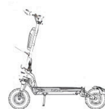
3. Priložte riadidlá a zafixujte ich svorkovým blokom a 4x šróbami
